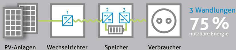
**Herkömmliche Speicher** sitzen hinter dem Wechselrichter. Strom vom Dach wird erst in Wechselstrom, dann zum Speichern wieder in Gleichstrom und zur Abgabe ins Haus wieder in Wechselstrom transformiert. So viele Wandlungen beeinträchtigen die Effizienz. Sie können nur rund 75 % Ihres Solarstroms nutzen.
