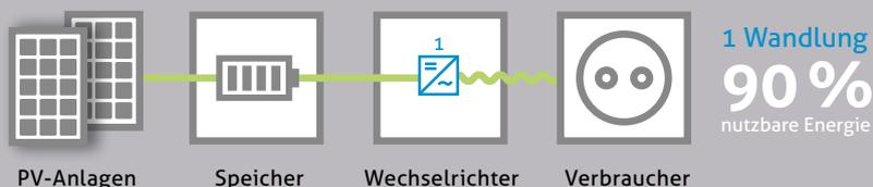
**MyReserve** hingegen wird vor dem Wechselrichter installiert. Er speichert direkt den Gleichstrom aus der PV-Anlage. Erst beim Verbrauch des Stroms im Haushalt wird er in Wechselstrom umgewandelt. Sie nutzen über 90 % Ihres eigenen Solarstroms. Das zahlt sich aus.
